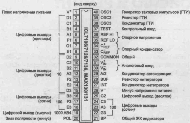
Рис. 2. Цоколевка АЦП 7106 в корпусе DIP-40
